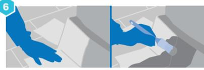
Refuerzo de esquinas antepechos terraza con **mallá de fibra de vidrio para terrazas 60gr/m<sup>2</sup>**
