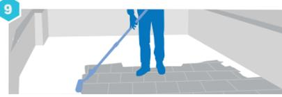
Aplicar una nueva mano de **ANTIGOTERAS** o **tkrom CUBIERTAS** para cubrir perfectamente la mallá de fibra de vidrio.
