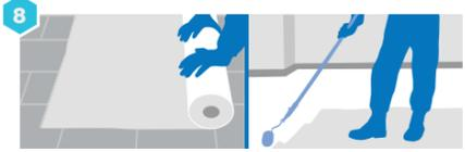
**tkrom ANTIGOTERAS** o **tkrom CUBIERTAS** + **mallá de fibra de vidrio para terrazas 60gr/m<sup>2</sup>**
