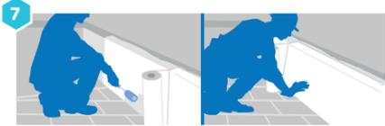
Refuerzo de esquinas antepechos terraza con **mallá de fibra de vidrio para terrazas 60gr/m<sup>2</sup>**
