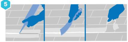
Reparación de juntas con relleno de juntas con movimiento con el producto adecuado.
