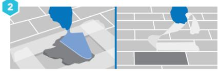
Reparar las zonas deterioradas con mortero **TKROMPLAST EXTERIOR-152**
