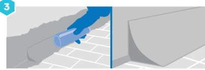
Realizar media caña con **ANTIGOTERAS** o **tkrom CUBIERTAS** y arena de cuarzo de 0,4mm (2:1 en volumen).
